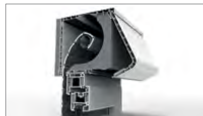
Schmalere Gehäusebox mit Revisionsabdeckung von der Rückseite (Bebauung von außen möglich)
